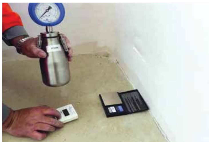
Mesure du taux d'humidité avec la méthode de la bombe à carbure.
