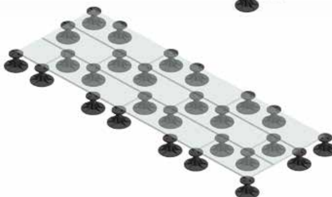
Figure 6 : Positionnement des plots en joints décalés d'un tiers de longueur avec un plot par angle et un plot intermédiaire au droit de chaque longueur - Exemple avec des dalles 30 x 90 cm
