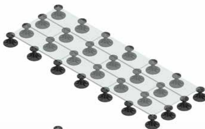
Figure 5 : Positionnement des plots en joints décalés d'une demi-longueur avec un plot par angle et un plot intermédiaire au droit de chaque longueur - Exemple avec des dalles 30 x 90 cm
